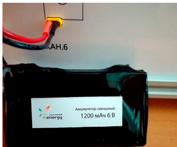
Рисунок 1 – К определению временных характеристик процесса разряда и заряда свинцовой аккумуляторной батареи (Стенд УМАКБ-1 InEnergy)
