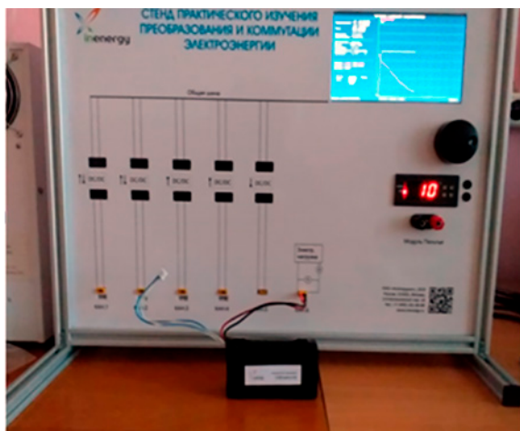
Рисунок 1 – К определению временных характеристик процесса разряда и заряда свинцовой аккумуляторной батареи (Стенд УМАКБ-1 InEnergy)
