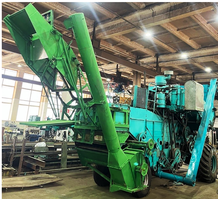
Рисунок 4 – Макетный образец устройства для сбора соевой половы Figure 4 – A mock-up sample of a device for soybean chaff collecting
