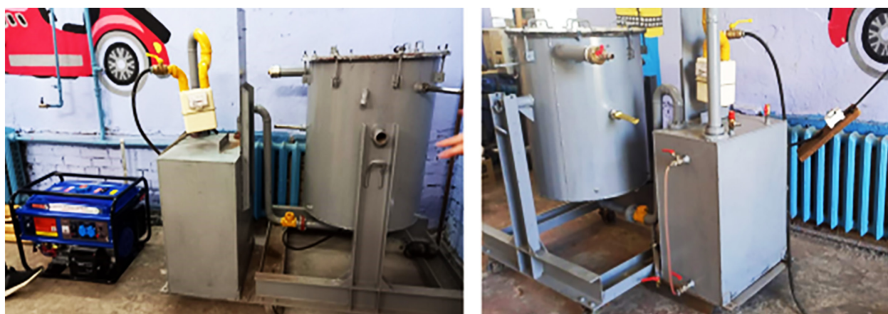
Рисунок 2 – Пиролизная установка ГВА-1 до модернизации (слева) и после модернизации (справа) Figure 2 – Pyrolysis unit GVA-1 before modernization (left) and after modernization (right)
