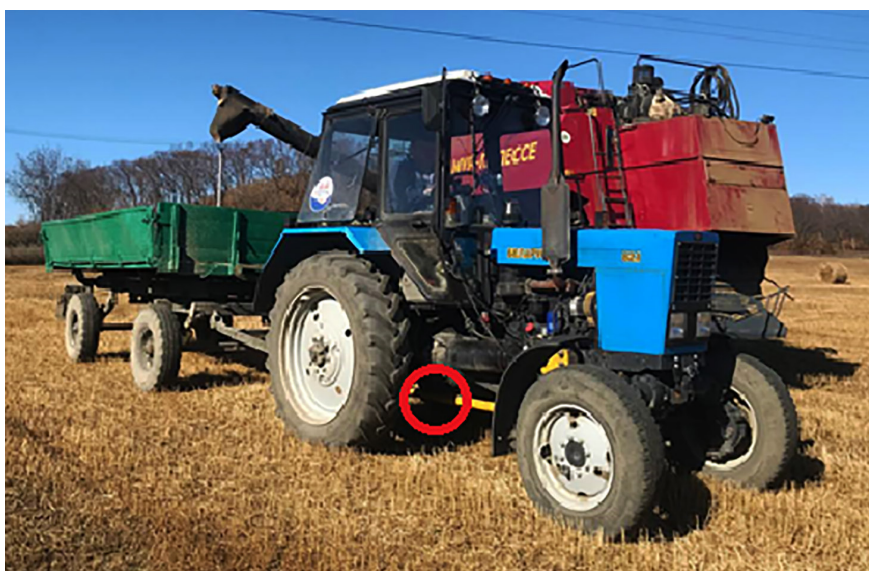
Рисунок 2 – Фрагмент производственных испытаний тракторно-транспортного агрегата с буксирно-распределительным устройством
