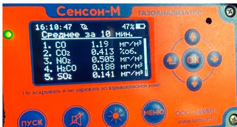
Рисунок 4 – Показатели газоанализатора «Сенсор-М» Figure 4 – Indicators of the Sensor-M gas analyzer
